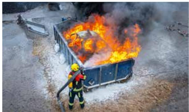
Erfolgreicher Brandtest von eCar-Cycle und Secontec in Zusammenarbeit mit der Feuerwehr, um Erkenntnisse für das Temperaturüberwachungssystem zu gewinnen
